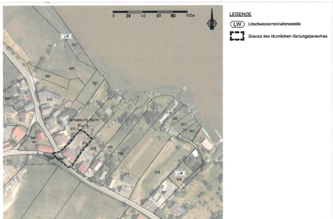
Für die vorgesehene Löschwasserversorgung aus dem Balmer See sind vorbereitete frostsichere Entnahmestellen erforderlich. Um die Löschwasserversorgung auch im Winter zu gewährleisten, müssen erfahrungsgemäß frostfreie Wasserentnahmestellen eingerichtet werden.
