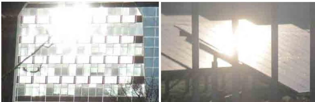
Abbildung 3: Gegenstände auf der Sichtachse zur Blendquelle sind nicht mehr wahrnehmbar
