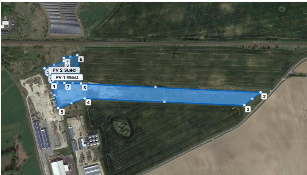
Abbildung 11: Anlage der geplanten PV-Freiflächenanlage in der Simulationssoftware ForgeSolar
