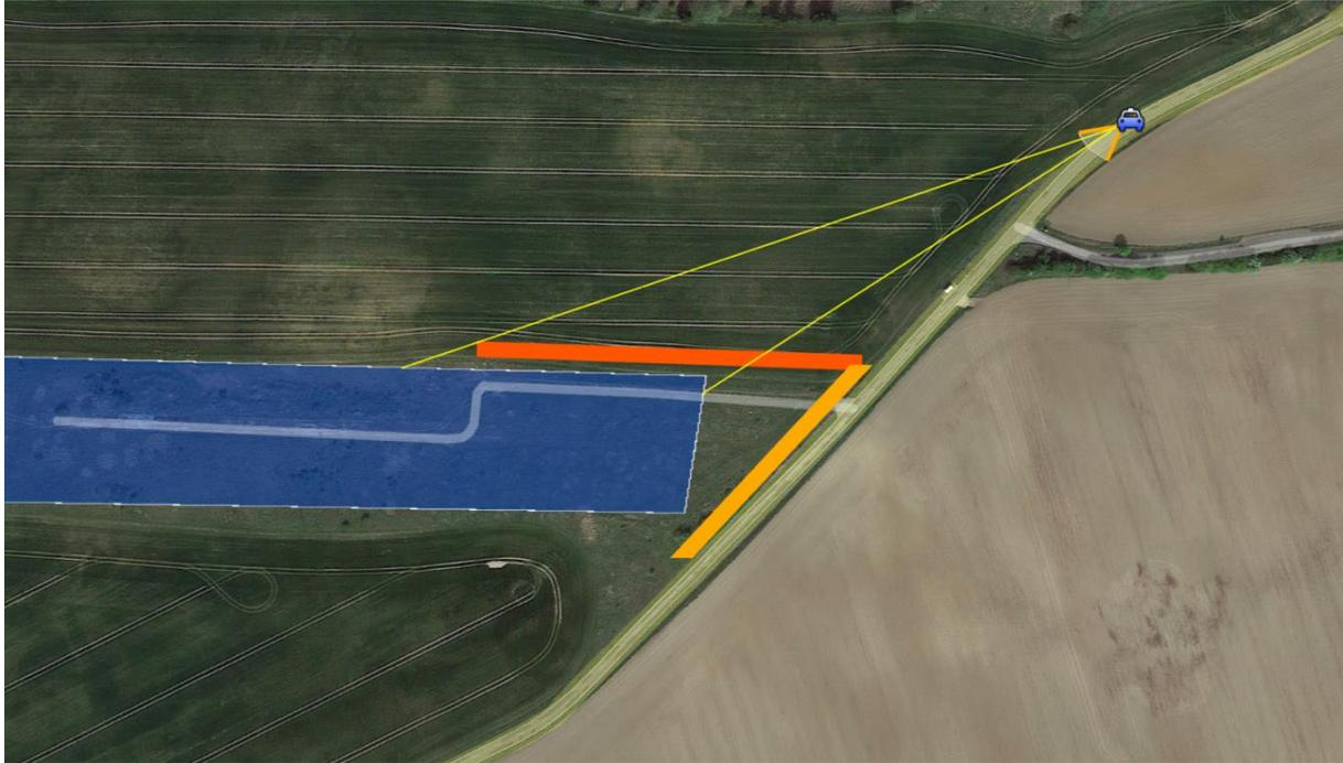
Abbildung 15: Potenzielle Blendung ausgehend von PV – Fläche Ost 1 auf die Kreisstraße UER5. Blau dargestellt ist die PV – Fläche, hell-orange markiert der Bereich, für den ein Wall geplant ist, dunkel-orange der Bereich, der die notwendige Länge des Sichtschutzauns darstellt und die gelben Linien, die die Reflexionswinkel, ausgehend vom Solarpark, verdeutlichen
