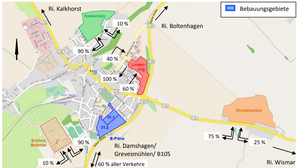
Abbildung 3-1: Verteilung der erzeugten Quell- und Zielverkehre der Entwicklungsgebiete (Abbildung auf Grundlage von OpenStreetMap)
