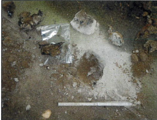
Bild 19: Bürogebäude I, EG, Raum K (Werkstatt), Probe 23547-13, Fußbodenfugen mit asbestfreier Fugenvergussmasse.
