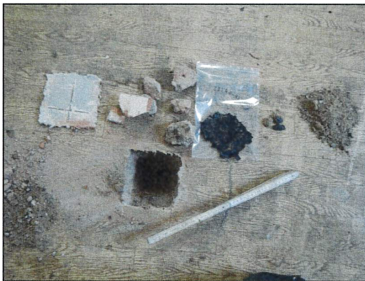
Bild 21: Wohnhaus I, EG, Wohnraum 4, Probe 23547-15, asbestfreie Teerpappe im Fußboden.
