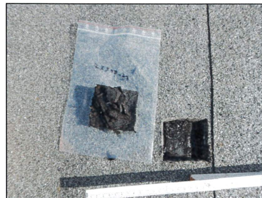
Bild 24: Laube C, Dach, Probe 23547-21, Teerpappe mit geringen Asbestgehalten als Dacheindeckung.
