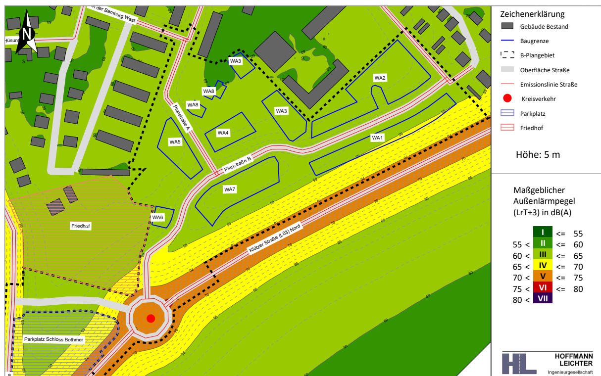
Abbildung 5-1 Maßgeblicher Außenlärmpegel gemäß DIN 4109 | Aufenthaltsräume in Wohnungen u. Ä. in 5 m Höhe über Gelände | ohne Lärmschutzmaßnahmen
