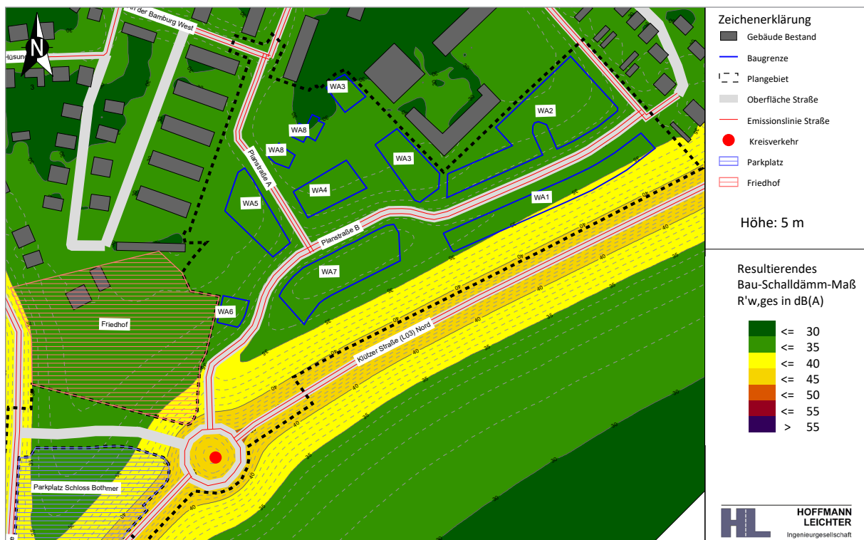
Abbildung 5-3 Erforderliches gesamtes bewertetes Bau-Schalldämm-Maß gemäß DIN 4109 | Aufenthaltsräume in Wohnungen u. Ä. in 5 m Höhe über Gelände | ohne Lärmschutzmaßnahmen
