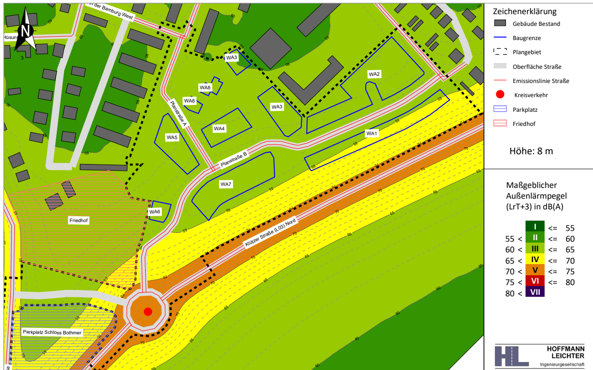
Abbildung 5-2 Maßgeblicher Außenlärmpegel gemäß DIN 4109 | Aufenthaltsräume in Wohnungen u. Ä. in 8 m Höhe über Gelände | ohne Lärmschutzmaßnahmen
