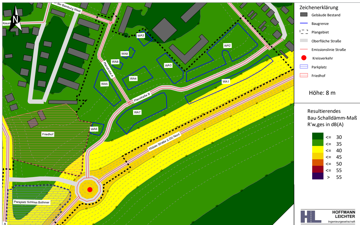
Abbildung 5-4 Erforderliches gesamt bewertetes Bau-Schalldämm-Maß gemäß DIN 4109 | Aufenthaltsräume in Wohnungen u. Ä in 8 m Höhe über Gelände | ohne Lärmschutzmaßnahmen
