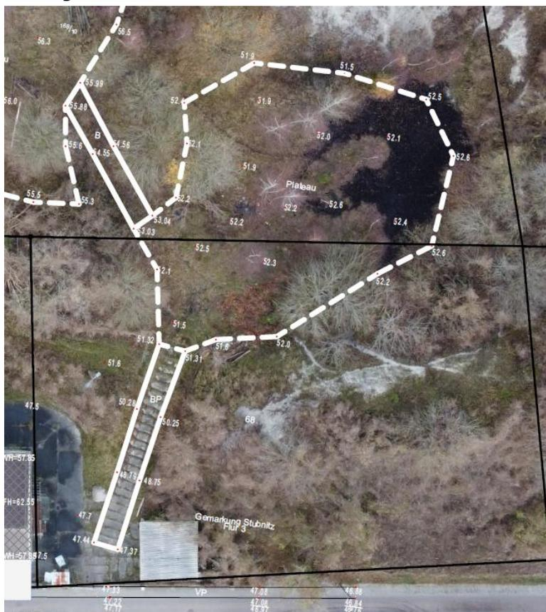
Abbildung 2 Aufmaß der Nichtholzbodenfläche sowie vorhandener Versiegelung und Teilversiegelung
