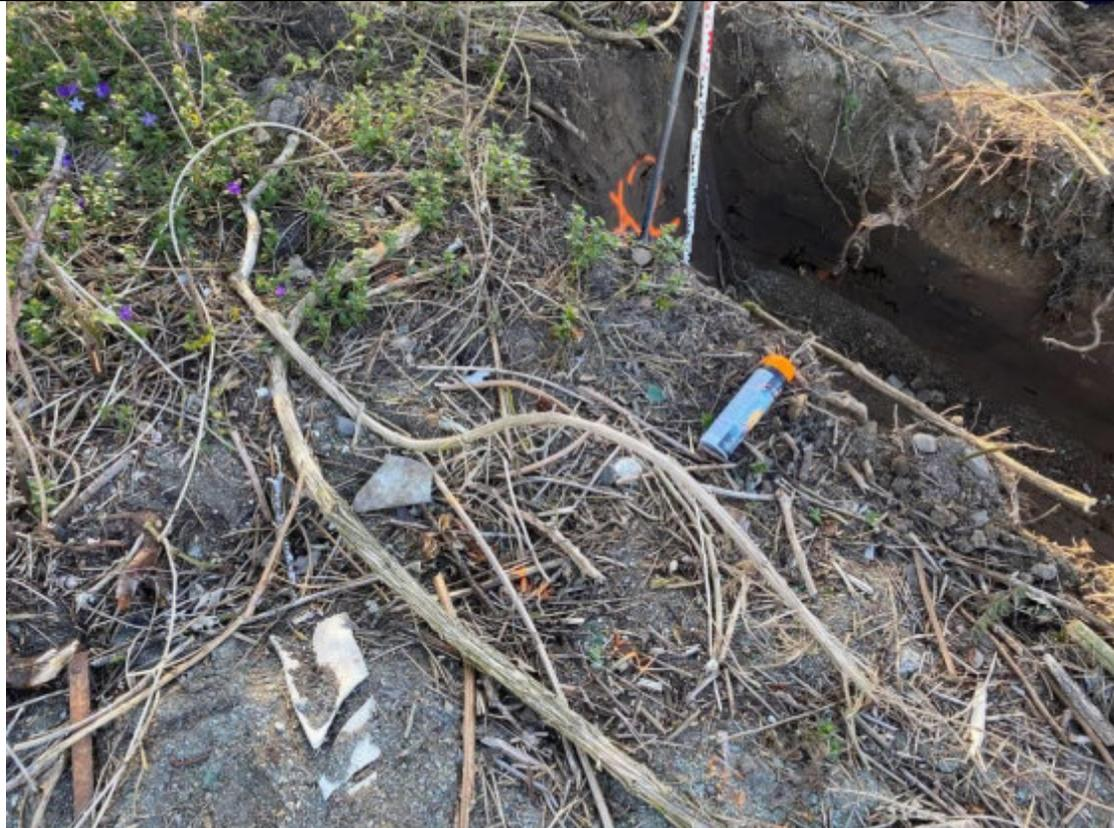
Asbestschurf A2 mit Gleisschotter
