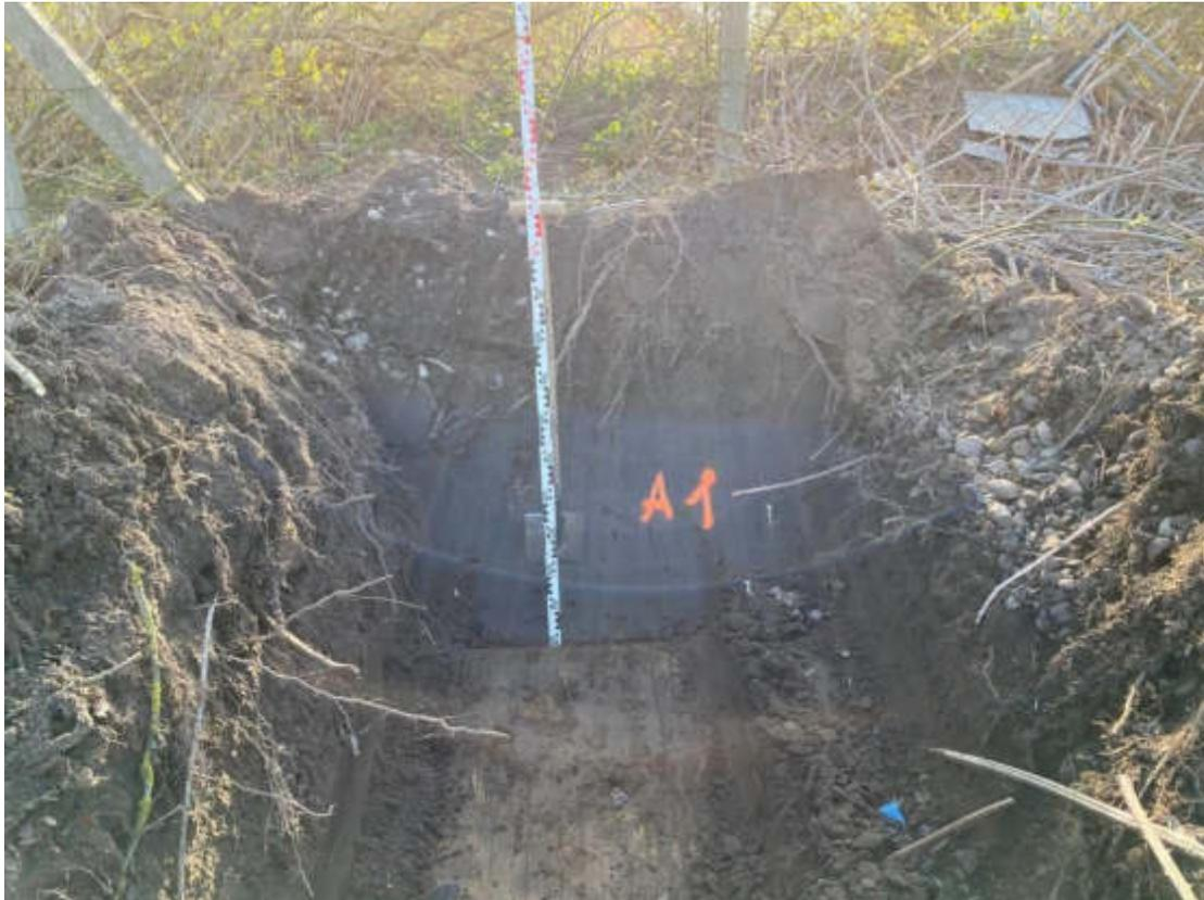
Asbestschurf A1 mit Gleisschotter
