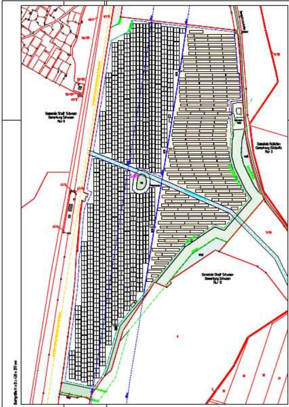
Abb.2-3: Belegungsplan für die Photovoltaikanlage Schwaan-Schiene (EAST ENERGY GMBH 2025)
