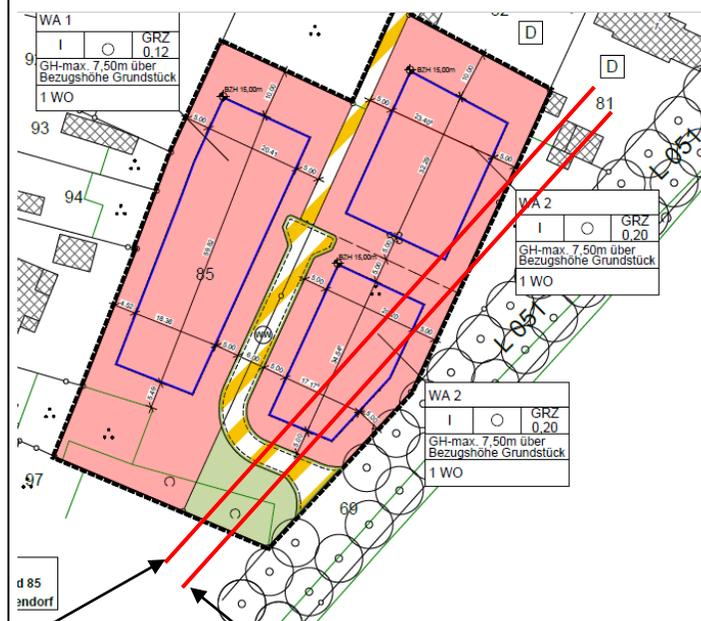
20 m Abstandslinie ; 15 m Abstandslinie
