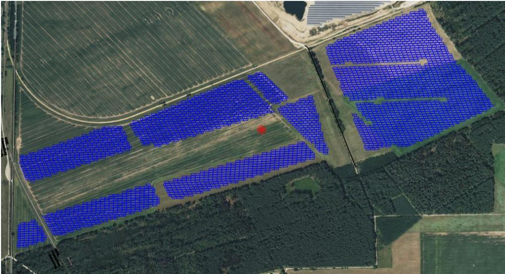
Abbildung 7: Derzeitiger noch nicht endgültiger Belegungsplan mit blau eingezeichneten Modultischen
