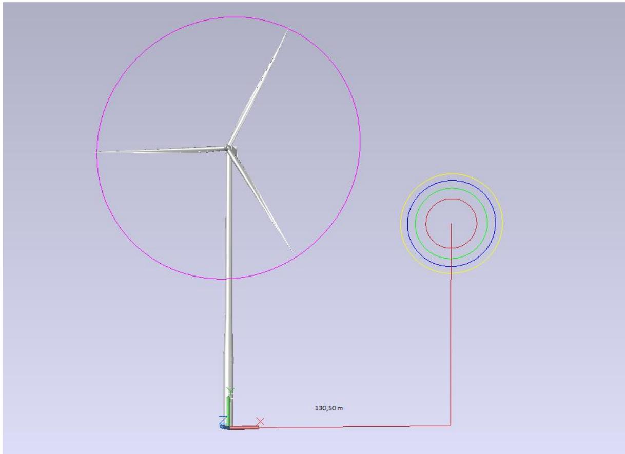
Abbildung 7: Systemdarstellung der WEA 8 in Bezug auf die Richtfunkstrecke des Landes Mecklenburg-Vorpommern. Angenommene Windrichtung aus südwestlicher Richtung [202,50°] zur Festlegung der Rotororientierung. Alle Maßangaben in Meter.
