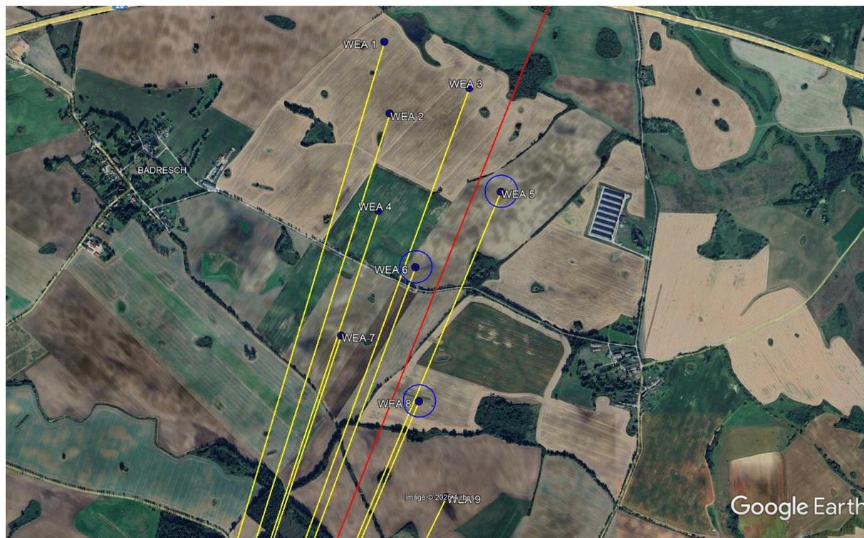
Abbildung 2: Detaildarstellung des projektierten Windparks Badresch. Die Punkt-zu-Punkt Verbindung der Richtfunkstrecke ist in Rot gekennzeichnet
