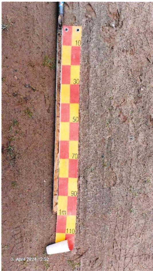
**Abbildung 1:** Beispiel einer Pürckhauer-Bohrung
