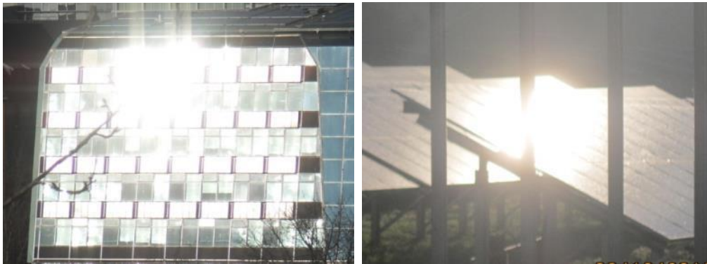
Abbildung 3: Gegenstände auf der Sichtachse zur Blendquelle sind nicht mehr wahrnehmbar
