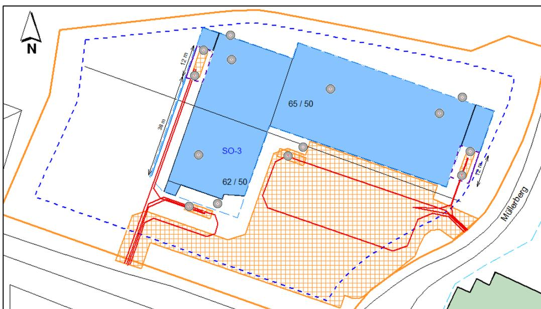
Abbildung 7: Prognosemodell zur Vorplanung mit Lärmschutzmaßnahmen
