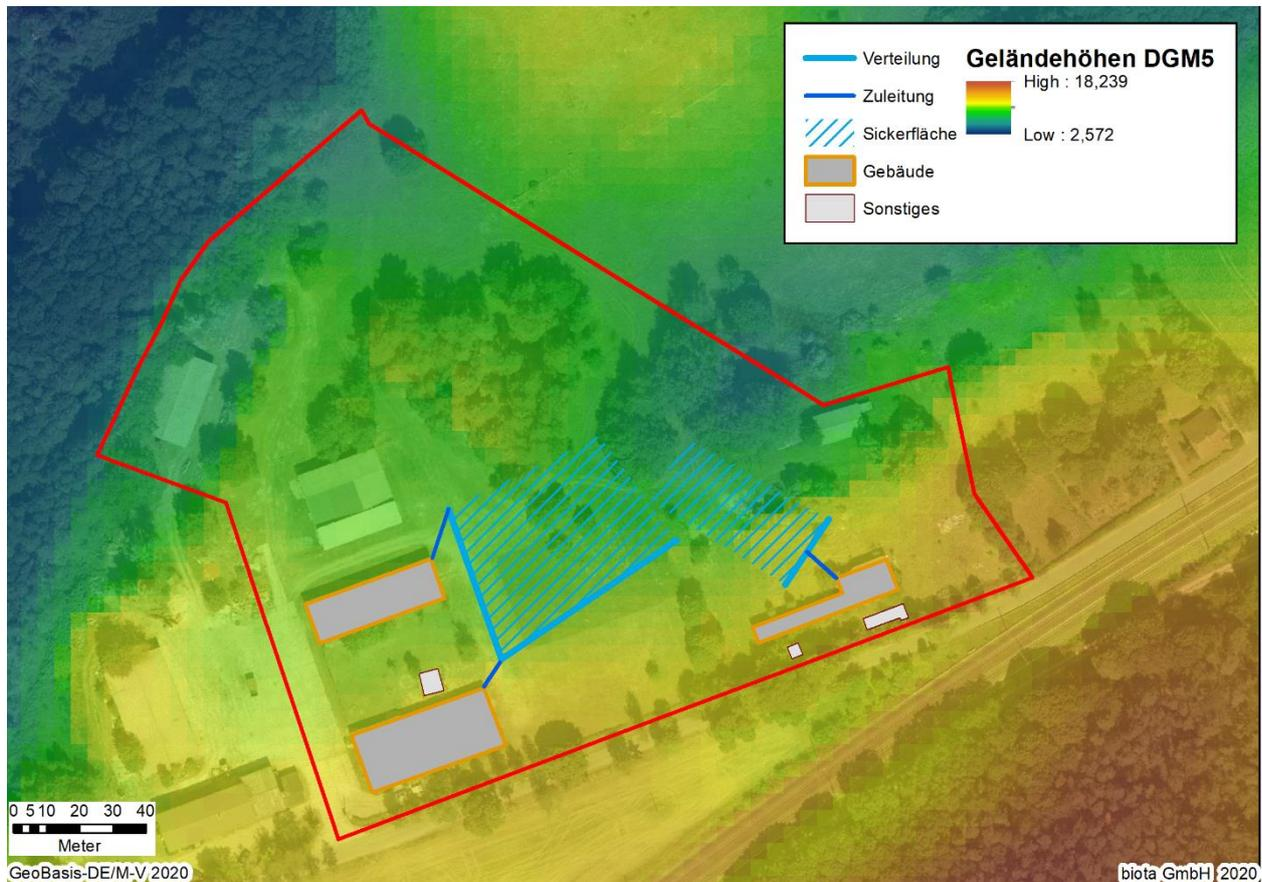
**Abbildung 3-6: Entwässerungsplan für die Ableitung des Regenwassers vom Wohn-/Ferienhaus, Reihalle und Lagerhaus**
