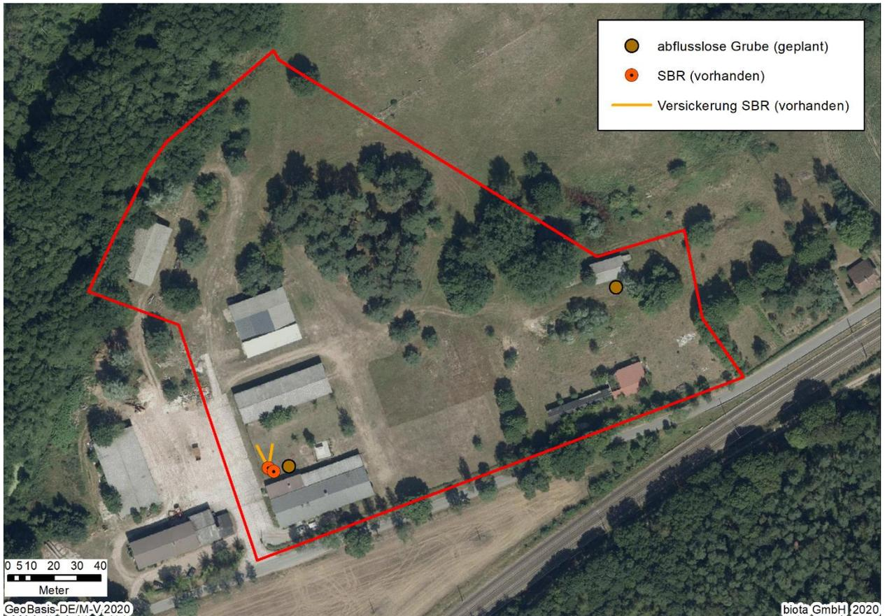
Abbildung 4-1: Lage der vorhandenen und geplanten Abwasseranlagen
