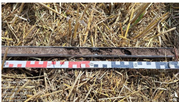
Foto 4: Nahaufnahme des Unterbodens
