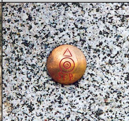
SFP Messingbolzen Ø 3 cm
