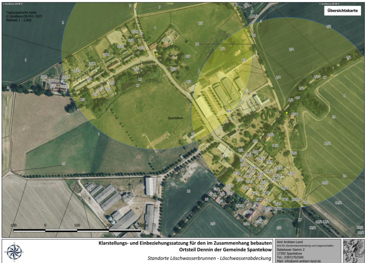
Abb. 01: Lage der geplanten Löschwasserentnahmestellen auf den Flurstücken 17, Flur 9 der Gemarkung Dennin und 13/3, Flur 7 der Gemarkung Dennin gekennzeichnet durch gelbe Punkte mit 300m-Radius
