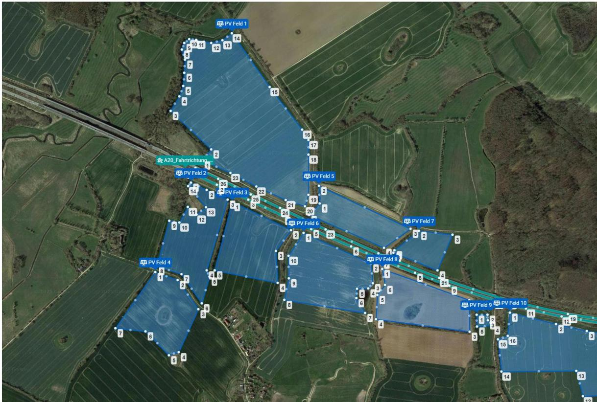
Abbildung 13: Anlage der PV-Flächen und Immissionsorte in der Simulationssoftware ForgeSolar (Teil 1)
