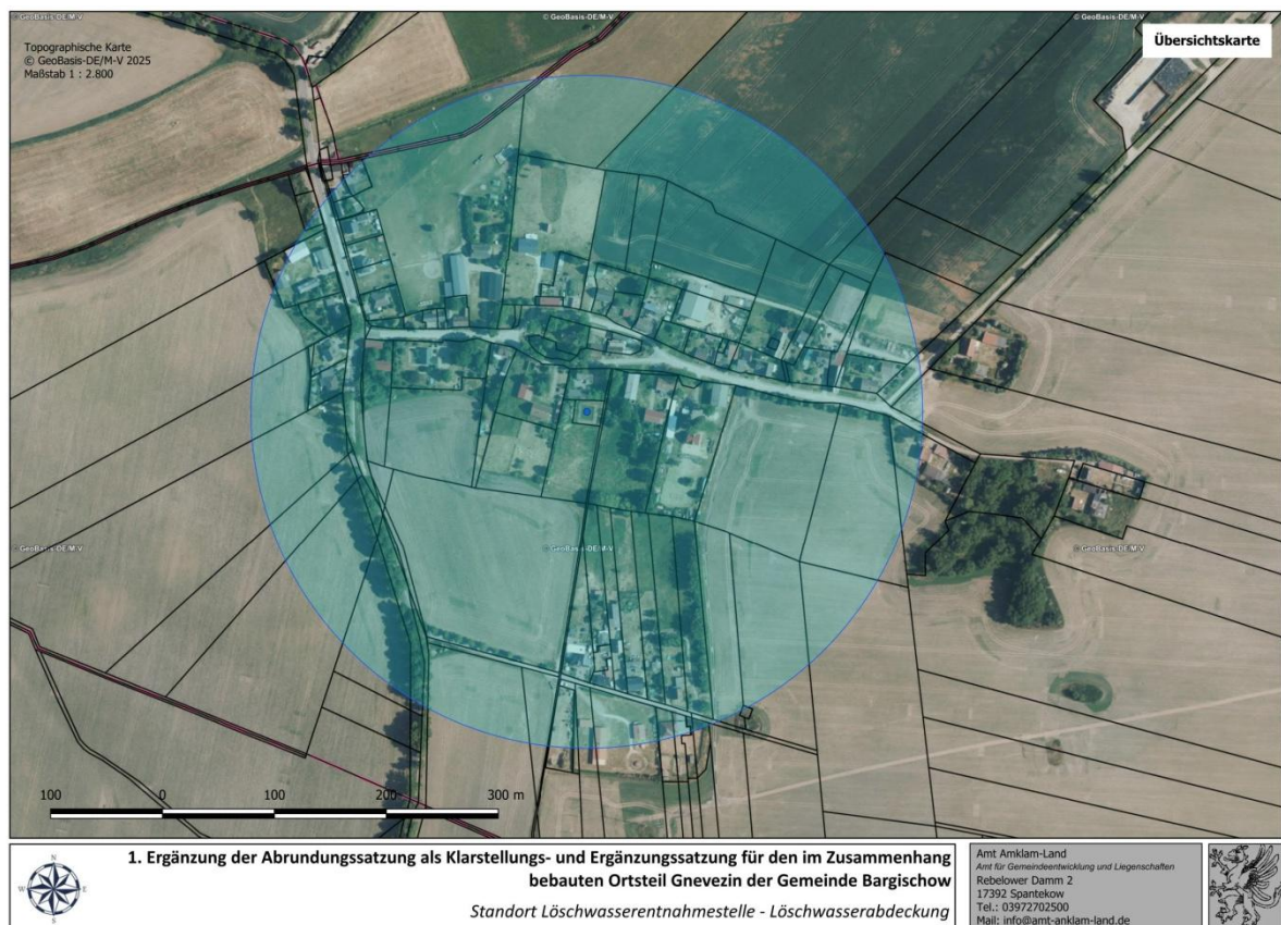
Abb.01: Löschwasserentnahmestelle (Folienlöschteich) auf dem Flurstück 84/4, Flur 1 der Gemarkung Gnevezin mit 300m-Radius
