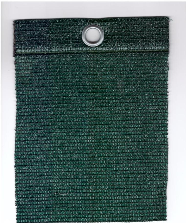
*Bild 4: Untersuchtes Kunststoffgewebe, Lieferant Fa. evia Verkehrstechnik GmbH/ACCURA NTV KG
