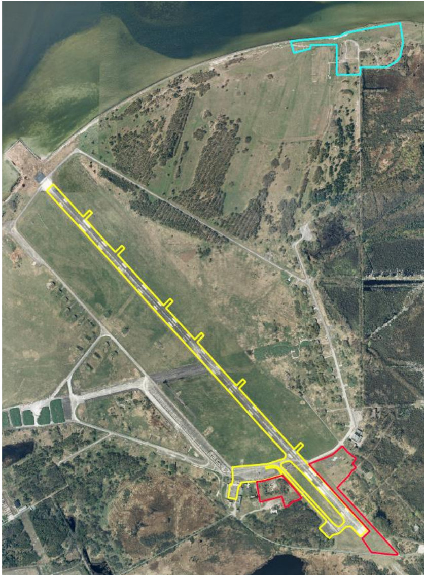
Abbildung 12: Verbringungsfläche von im Baufeld angetroffenen Glattnattern und Zauneidechsen (blau, VM 4), einzuhaltende Trassen für Baufahrzeugverkehr und Materiallagerung (gelb, VM 5), Flächen zur Habitataufwertung (CEF 1, rot)
