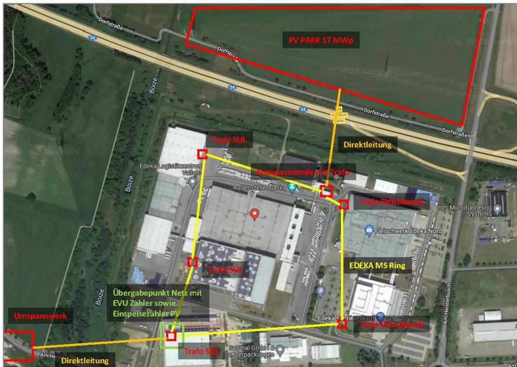
Abb. 1: Schaubild EDEKA Mittelspannungs-(MS)Ring
