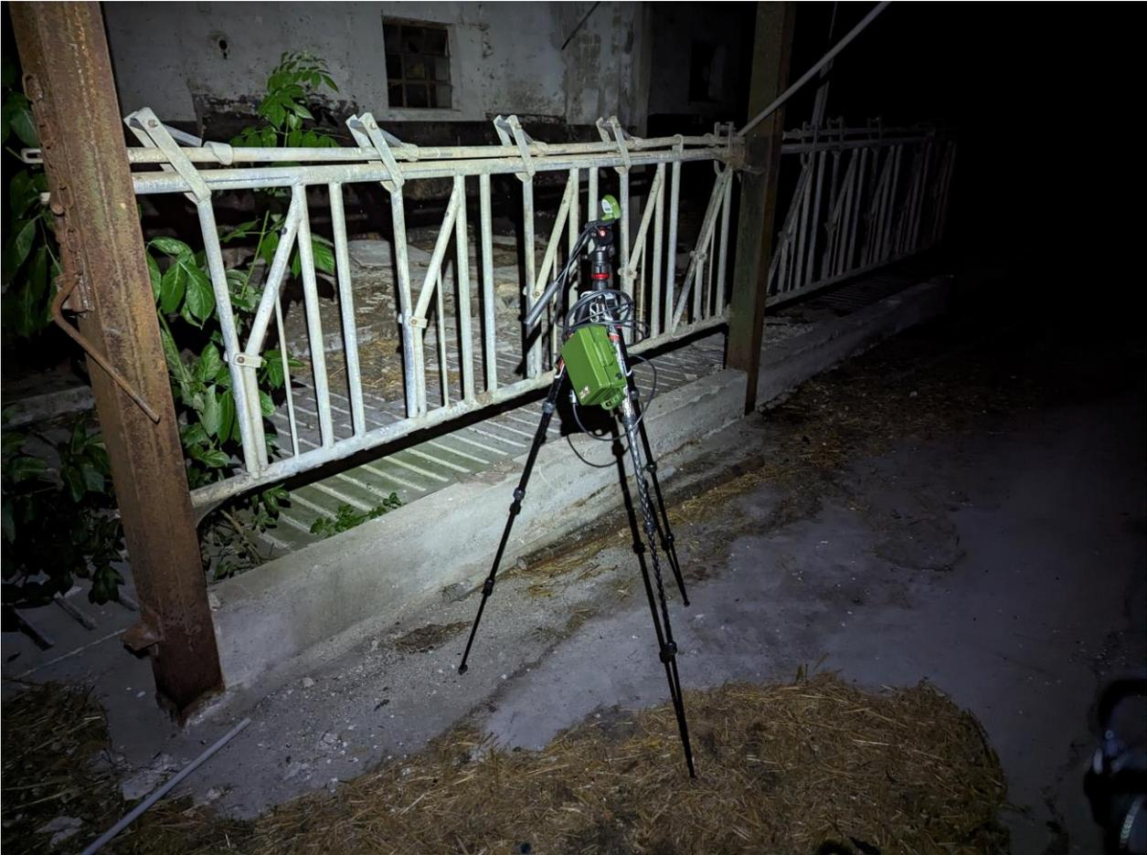
Abbildung 3: Auf Stativ angebrachte Horchbox mit ausrichtbarem Mikrofon.
