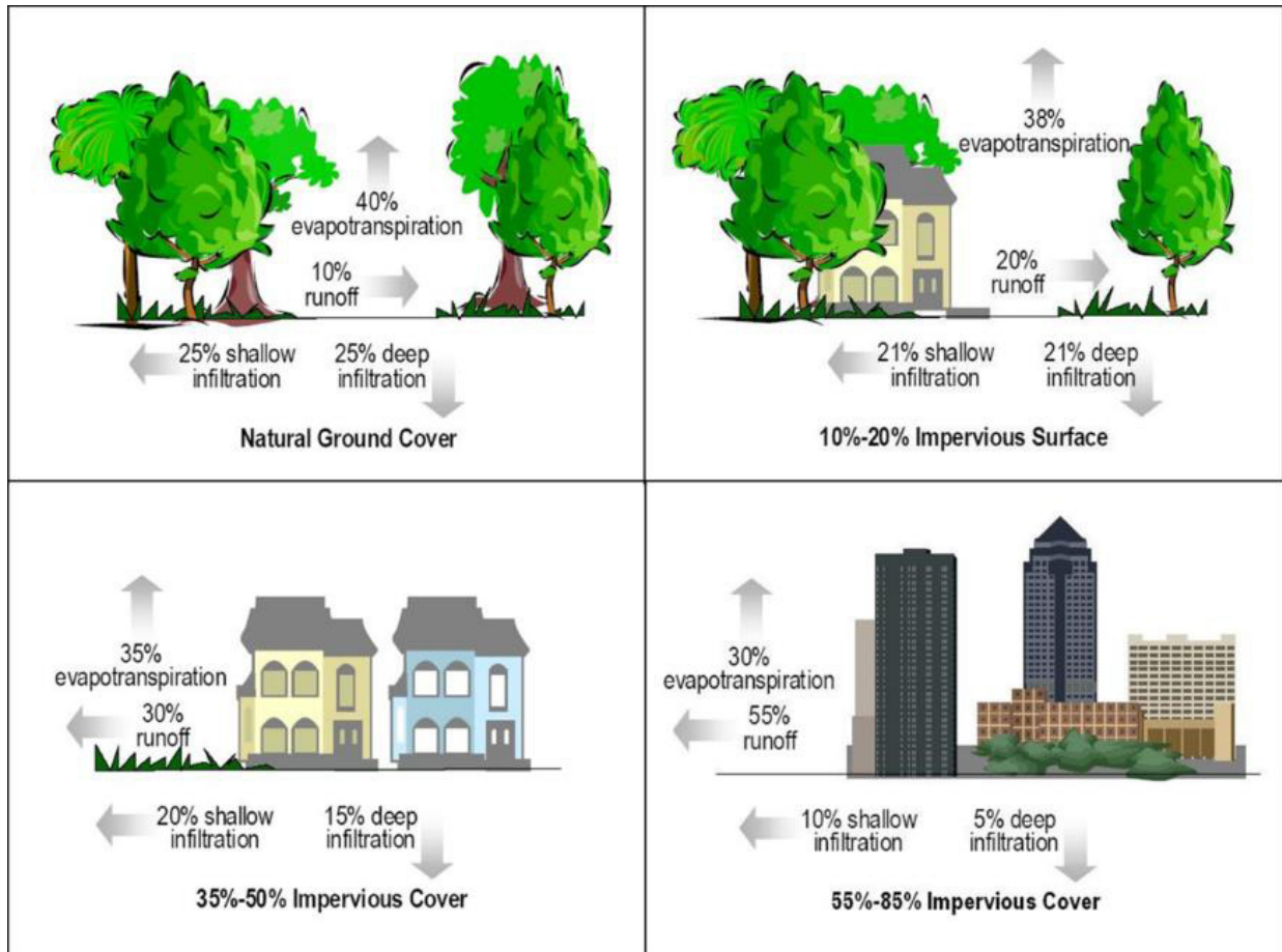
Abbildung 2-1: Schematische Darstellung der Wasserhaushaltsgrößen bei unterschiedlich starker Versiegelung
