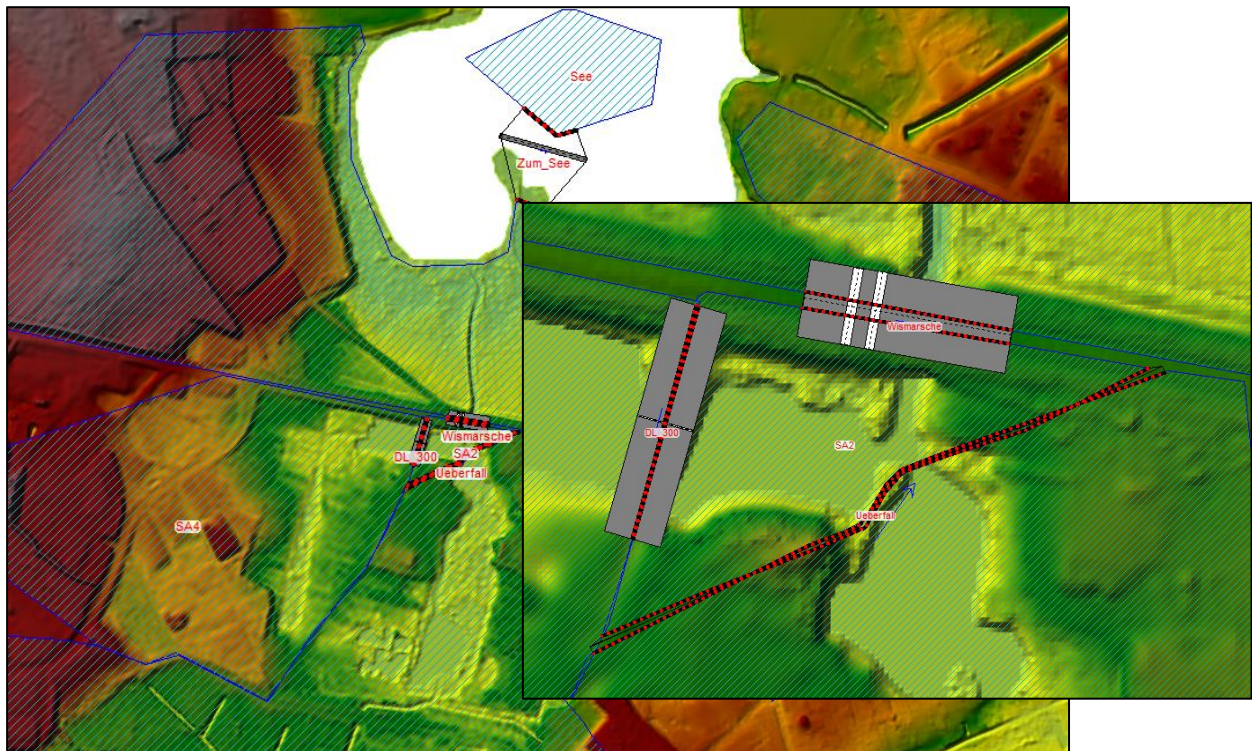
Abbildung 3-5: Hydraulisches Modell an der Wismarschen Str. (Ausschnitt) mit wesentlichen Geometrien, eindimensionale Betrachtung der Untersuchungsgewässer sowie der Vorlandflächen mit farblicher Abstufung der Geländehöhen (DGM 1 und 25, © GeoBasis-DE/M-V 2022)
