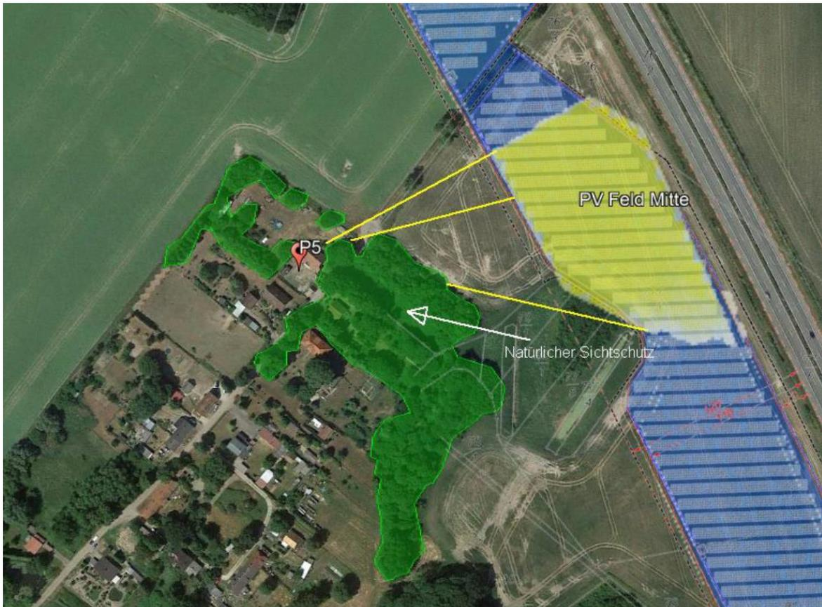
Abbildung 5: Simulation Messpunkt P5, Quelle: SolPEG GmbH 2020: Blendgutachten für den Solarpark Bandelin, S. 21.
