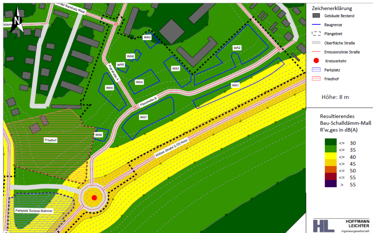
Karte 2: Erforderliches gesamtes bewertetes Bau-Schalldämm-Maß gemäß DIN 4109 | Aufenthaltsräume in Wohnungen u. Ä in 8 m Höhe über Gelände | ohne Lärmschutzmaßnahmen
