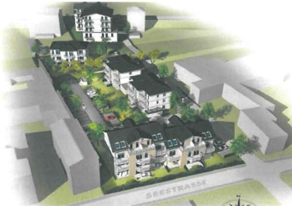
Demzufolge sollen die erforderlichen Nebenanlagen weitestgehend in die teils überdachten PKW-Stellplätze integriert bzw. in einem eingeschossigen Verbindungsbau zwischen den Häusern angeordnet werden.
