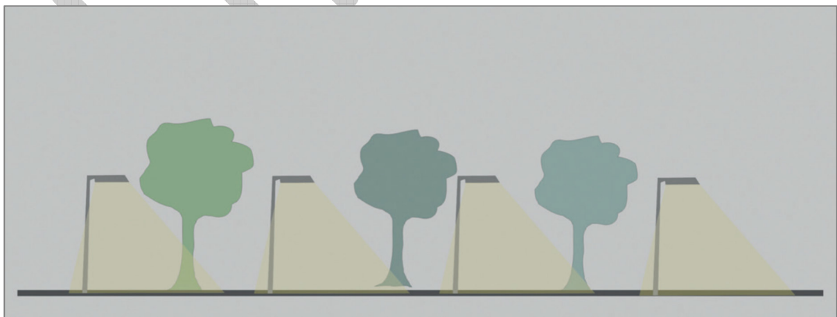
Abbildung 13: Beispiel für abgeschirmte Leuchten auf kurzen Masten zur Verhinderung von Lichtimmissionen in benachbarte Jagdhabitats, Quelle: H. LIMPENS IN EUROBATS, 2019.
