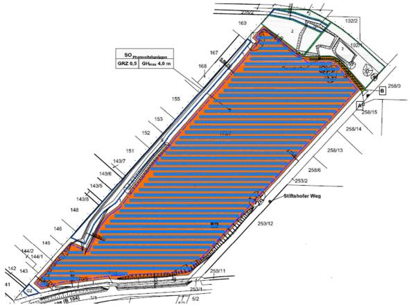
Abbildung 2: Modulbelegungsplan der PVA-Pasewalk
