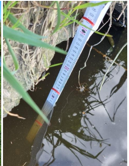
Abb. 9: Wassertiefe Zulauf etwa 37,0 cm
