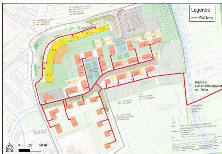
Abbildung 10: Mögliches Fernwärmenetz oberirdisch
