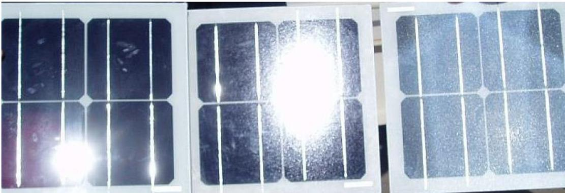
Bild 3.2.3: Diffuse Reflexion von unterschiedlichen Moduloberflächen (Quelle: Sandia National Laboratories)
