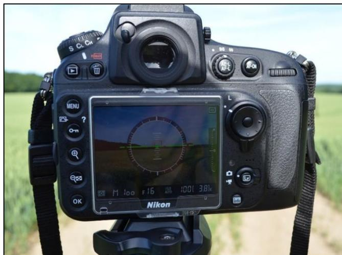
**Abb. 2:** Darstellung des künstlichen Horizonts im Kameradisplay der eingesetzten NIKON D800.
