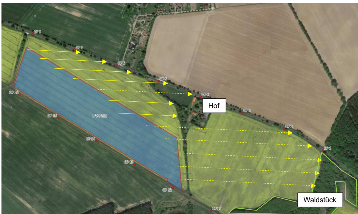
Abbildung 15: Skizze der Reflexionen auf die B 321: Gestrichelte Pfeile deuten teilweise von Vegetation blockierte Reflexionen an; auch wenn Reflexionen in Richtung Hof auftreten werden, sind dort keine erheblichen Belästigungen zu erwarten (siehe Kapitel 7.1) - Quelle Satellitenbild: Google Earth Pro
