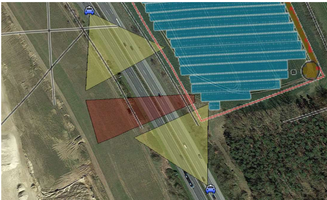
Abbildung 13 mögliche horizontnahe Reflexionswinkel der PV-Module in Rot und relevante Sichtwinkel der Verkehrsteilnehmer in Gelb (2)
