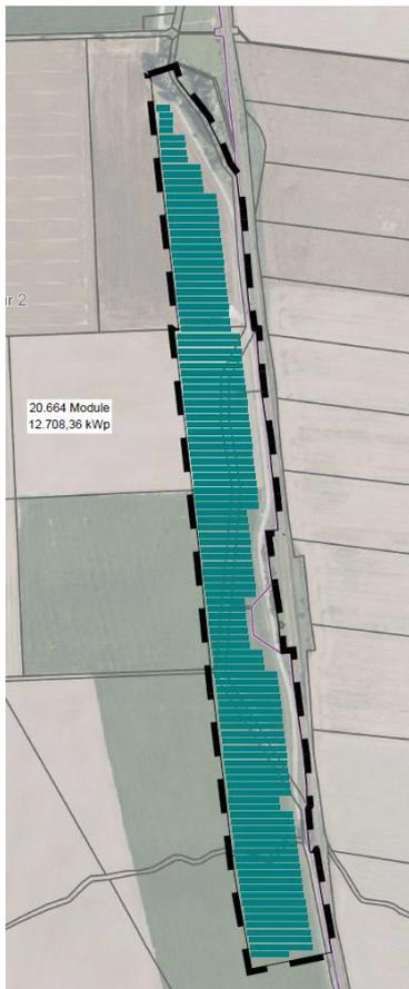
Abbildung 2: Modulbelegungsplan (Quelle: Auftraggeber)
