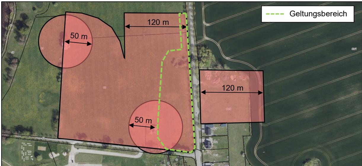
**Abbildung 4:** Darstellung der Abstandsflächen zu Vertikalstrukturen (Einzelbäume 50 m, Baumreihen 120 m)
