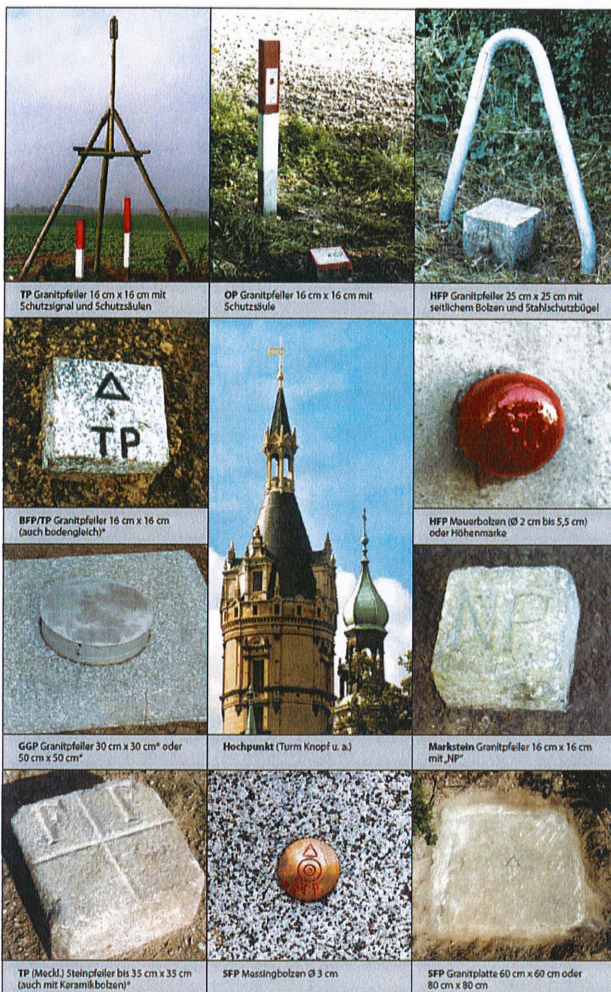
Festlegungsarten der Festpunkte der geodätischen Lage-, Höhen- und Schwerenetze
