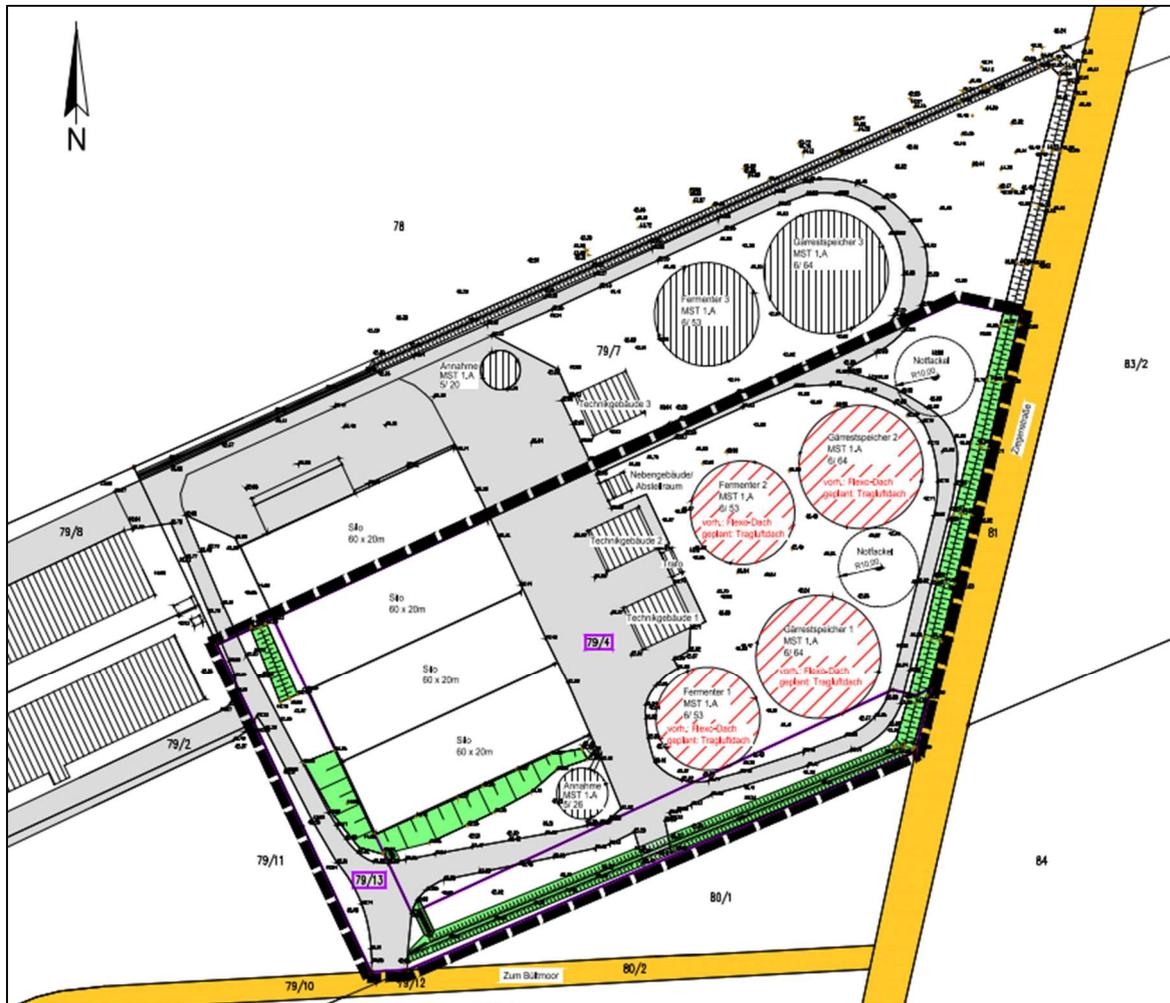
**Abbildung 1 Darstellung der Biogasanlage (Module 1 und 2) im Geltungsbereich der 1. Änderung des vB-Plans Nr. 4** (Quelle: Ausschnitt Vorhaben- und Erschließungsplan - Planungsbüro von Lehmden, Stand 02/2024) (rote Flächen - geplante Änderung der baulichen Anlagen, graue Flächen – vorhandene private Verkehrsflächen, gelbe Flächen – vorhandene öffentliche Verkehrsflächen, grüne Flächen – vorhandene Grünflächen)
