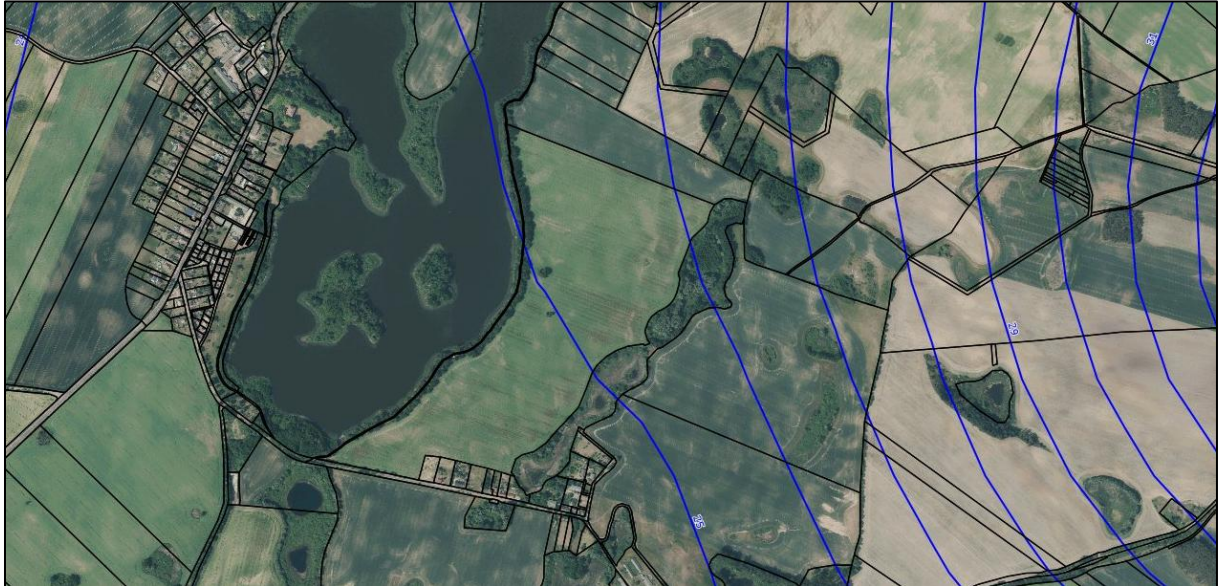
Abbildung 3: Grundwasserhöhengleichen (Grundwasserfließrichtung blau skizziert)
