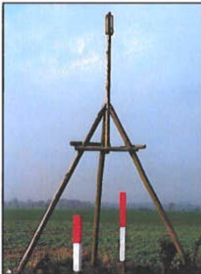
TP Granitpfähler 16 cm x 16 cm mit Schutzsignal und Schutzsäulen
