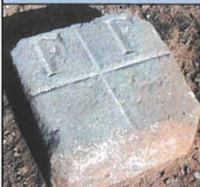
TP (Meckl.) Steinpfähler bis 35 cm x 35 cm (auch mit Keramikbolzen)*
