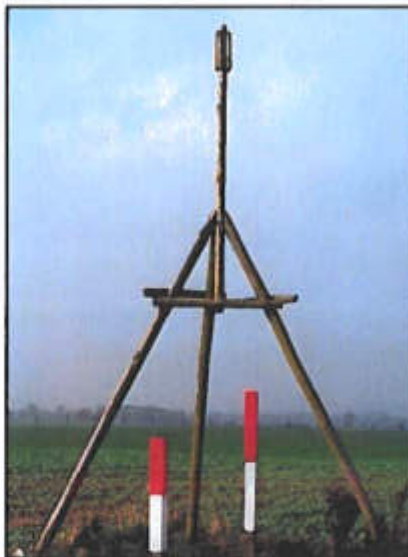
TP Granitpfeller 16 cm x 16 cm mit Schutzsignal und Schutzsäulen
