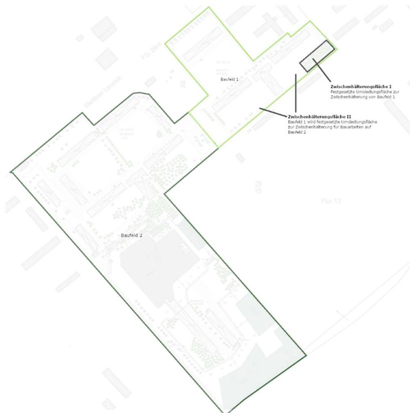
**Abbildung 1: Einteilung des Plangebietes in zwei Baufelder. Hintergrund, die unterschiedliche Anbindung an das elektrische Netz. Die Errichtung der Anlagen ist in zwei Bauphasen unterteilt. Für Informationen zu Zwischenhalterungsflächen siehe Ausführungsplanung CEF Zauneidechse.**
