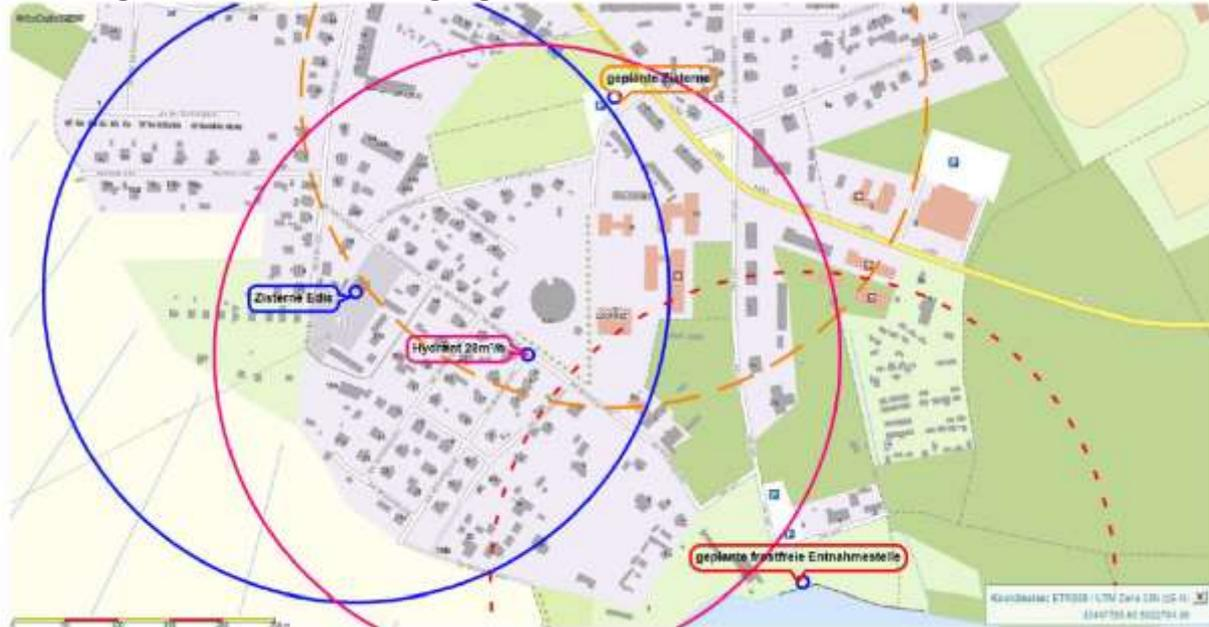
Derzeit steht im 300m-Umkreis nur ein Hydrant mit einer Leistung von 28 m<sup>3</sup>/h zur Verfügung. Die geplante frostfreie Löschwasserentnahmestelle am Löcknitzer See kann den Bedarf für den Bebauungsplan abdecken.
