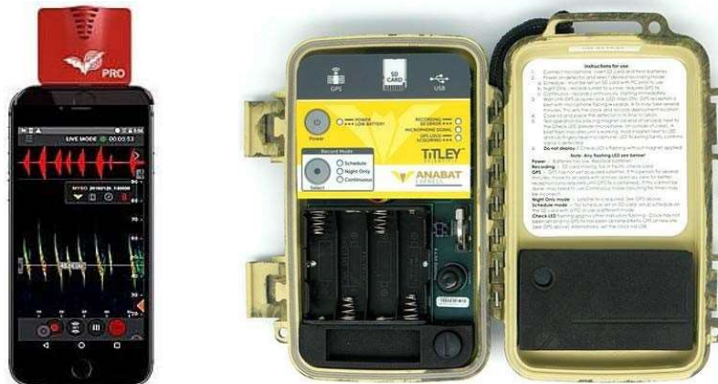
Abb. 6-1:: U.a. eingesetzte Bat-Detektoren; links Hand-Fledermaus-Detektor CIEL-electronique CDB 301, rechts Anabat Express, der auch als stationärer Fledermaus-Detektor eingesetzt werden kann
