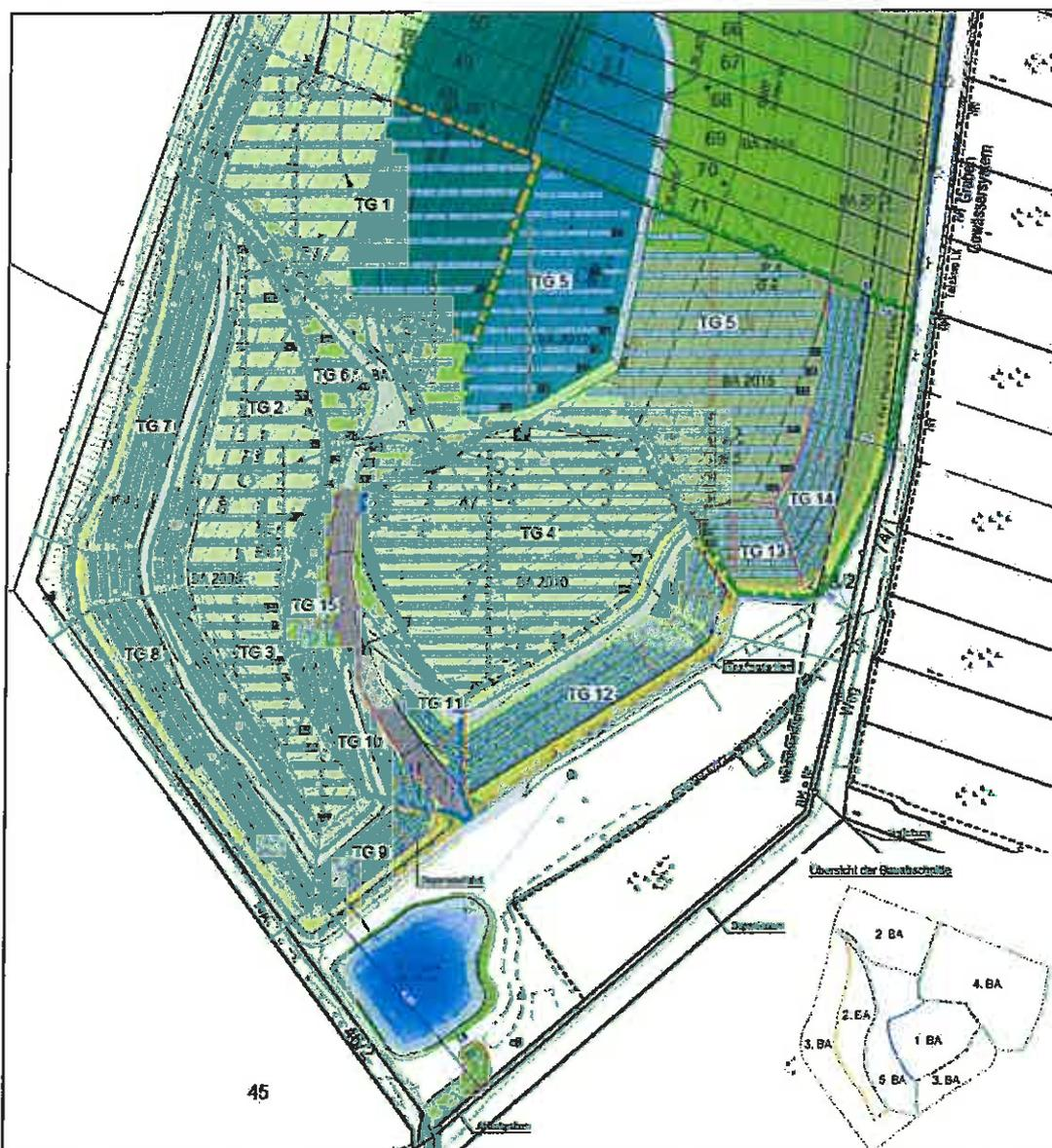
Abbildung 3: Modulbelegungsplan kleine Abbildung rechtsunten: Übersicht der Bauabschnitte; Quelle: SIG 2012.
