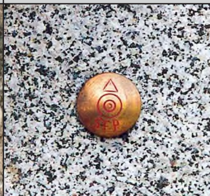
SFP Messingbolzen Ø 3 cm
