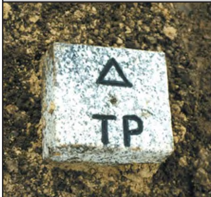
BFP/TP Granitpfeiler 16 cm x 16 cm (auch bodengleich)*
